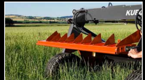
Die beiden Schwadleitbleche werden ausgebaut.
