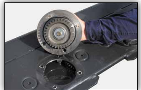
Nach oben abnehmbare Mähscheibenlagerung.
