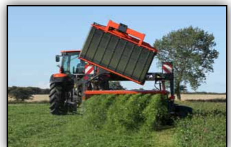
Das Erntegut wird direkt aufgenommen und vom ungemähtem Bestand weggeführt.
