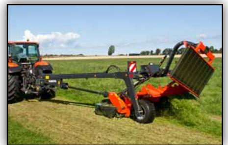
Beim ersten Durchgang wird ein normales Schwad abgelegt. Beim zweiten Durchgang wird das Band abgesenkt.
