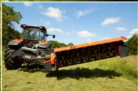
Vorgewendeaushub mit ausreichender Bodenfreiheit.
