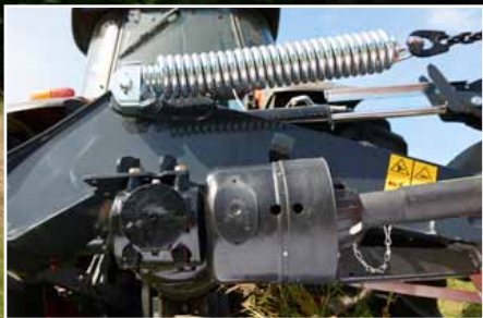
Die Zapfwellengeschwindigkeit kann durch Drehen des Getriebes von 540 U/min auf 1000 U/min geändert werden.
