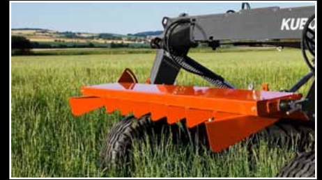
Einfache Umstellung von Breit- auf Schwadablage bei DMC8000 und DMC8500.
