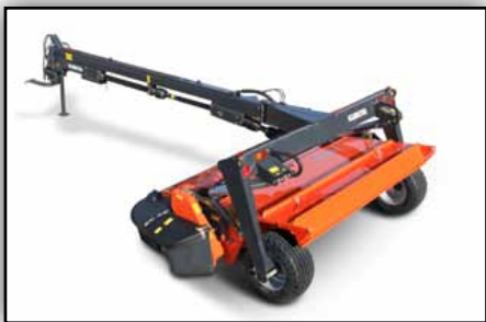
DMC8500T Serie – Gezogene Mähwerke mit mittiger Zugdeichsel, Stahlfinger-aufbereiter und 3,20 m Arbeitsbreite.
