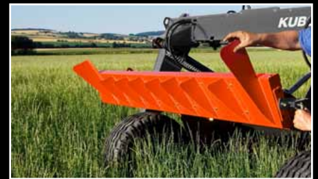
Zum Umschalten zwischen Schwadablage und Breitreuen werden die Streuflügel einfach um 180° nach oben gedreht.
