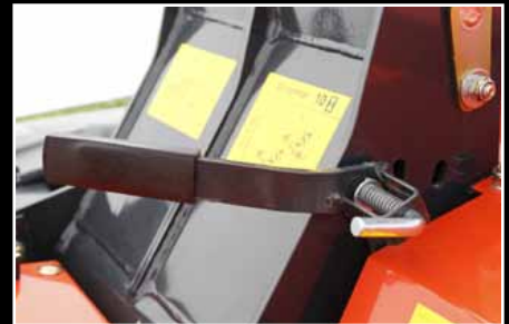
Die Aufbereitungsintensität kann in drei Stufen verstellt werden.
