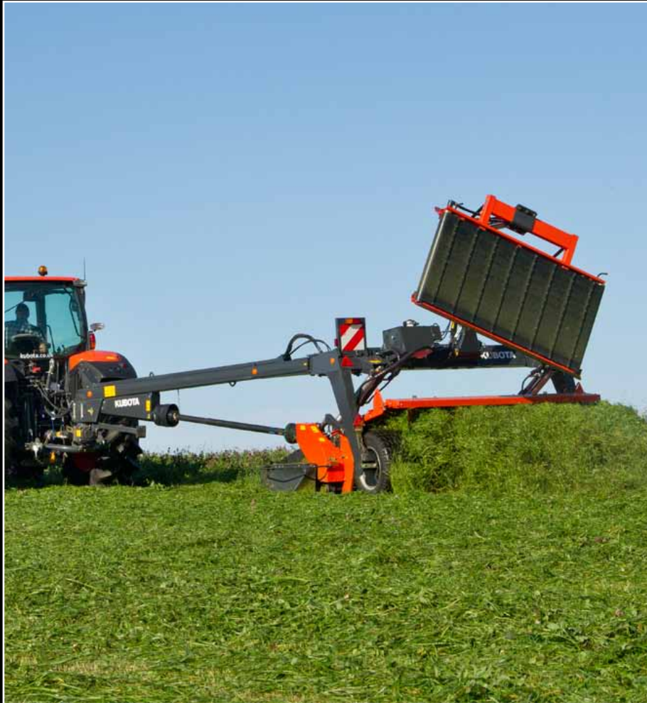
Einfache Umstellung von Breit- auf Schwadablage bei DMC8000 und DMC8500.
