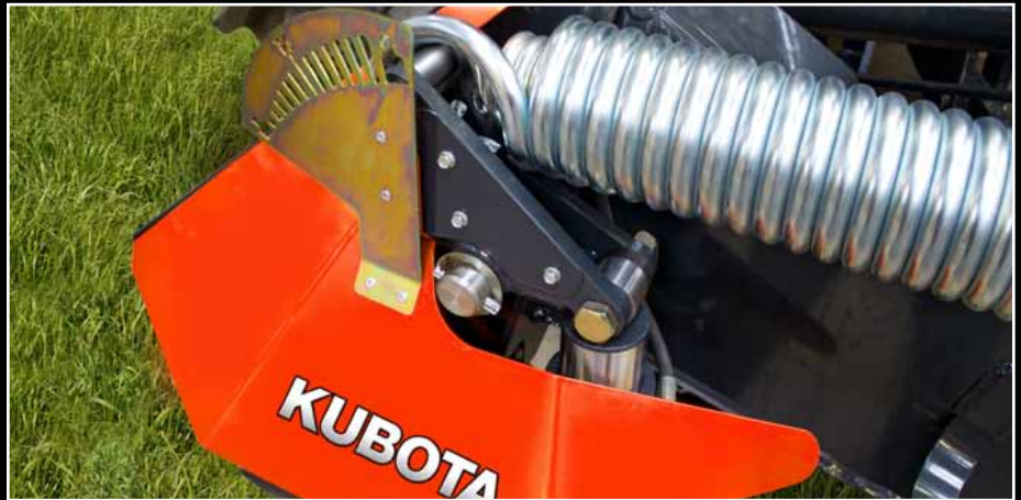
Schnelle Umstellung von Schwadablage auf Breitablage.
