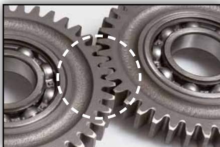
Speziell konstruierte Zahnräder mit abgerundeten Flanken und langen Zähnen sorgen für einen kraftschlüssigen und geräuscharmen Antrieb.
