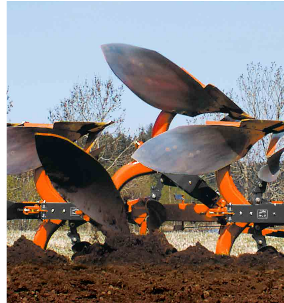
RM2005/RM2005V mit leistungsfähiger Blattfedersteinsicherung
