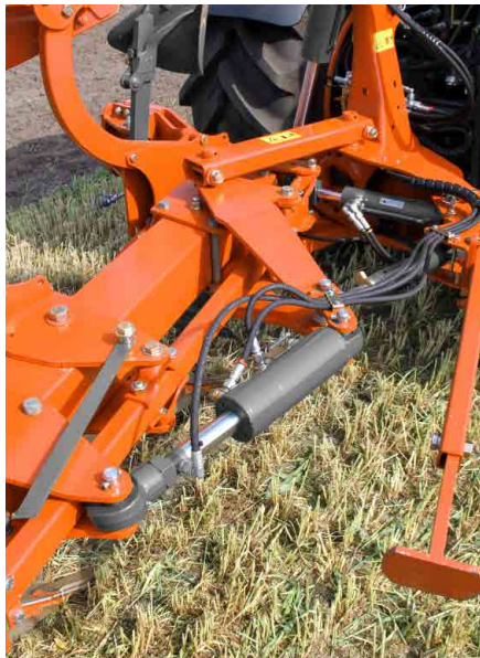
Parallelogrammführung mit Memoryzylinder und hydraulischer Einstellung der Vorderfurche (Master/Slave-System).
