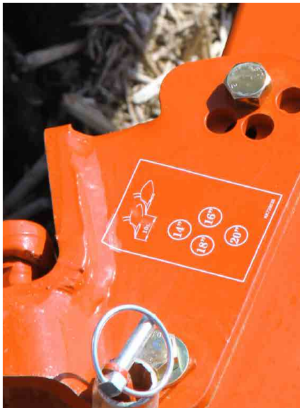
Einfache, stufenweise Einstellung der Schnittbreite bei RM2000-RM2005. Nur ein Bolzen ist umzustecken.
