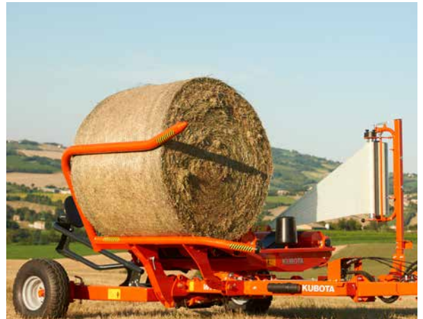
Der hydraulische Ladearm lädt den Rundballen schnell und sicher auf den Wickeltisch.
