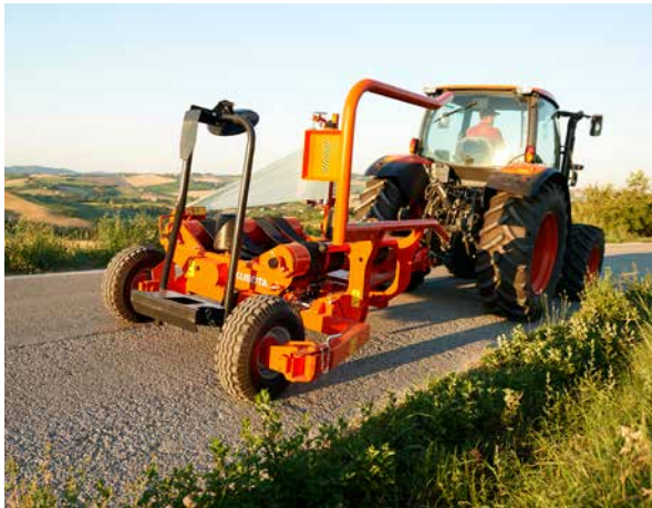
Für eine kompakte Transportbreite wird das rechte Rad nach innen gedreht.
