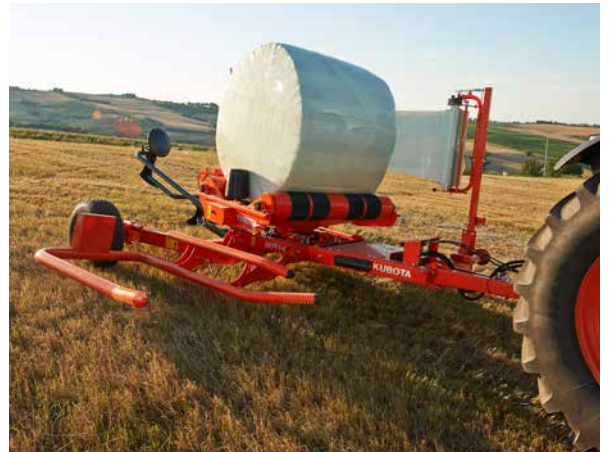
Der Drehtisch mit zwei angetriebenen Rollen ist für schwere Ballen und eine gleichmäßige Ballenrotation ausgelegt.
