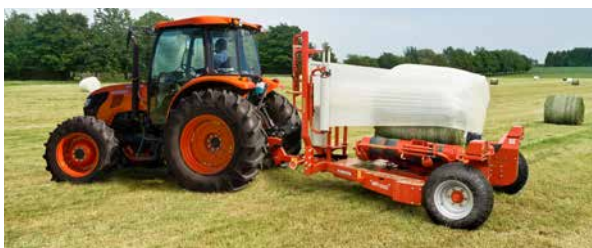
Die tiefe Drehtischposition erlaubt höhere Wickelgeschwindigkeiten.
