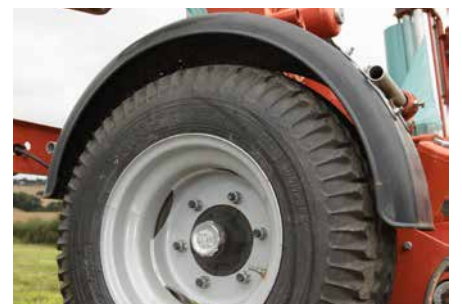
Die Kotflügel reduzieren die Verschmutzung an den Vorstreckern und Folienrollen.
