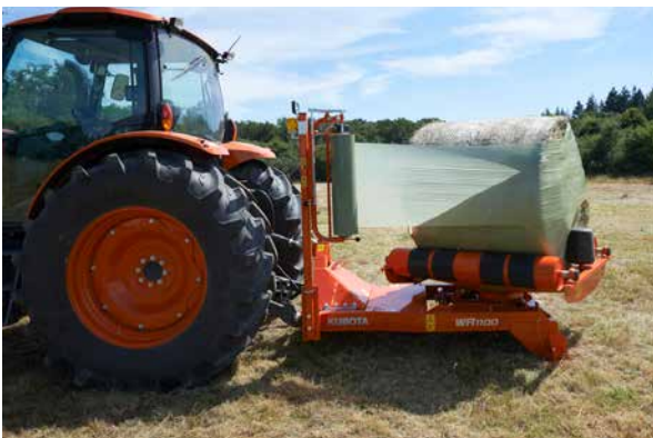
Vier Endlosriemen für eine sichere Ballenrotation.
