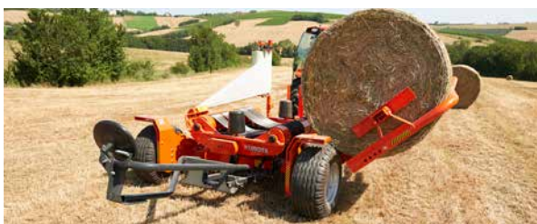
Die geringe Wickeltischhöhe reduziert die Ladezeit auf ein Minimum.
