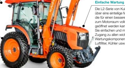
Die L2-Serie von Kubota verfügt über eine einteilige Motorhaube, die für einen besseren Zugang zum Motorraum vollständig geöffnet werden kann. So haben Sie einfachen und mühelosen Zugang zu allen wichtigen Wartungskomponenten, wie z. B. Luftfilter, Kühler usw.
